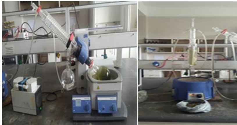
شکل ۱. عصاره‌گیری با روش سوکسوله و خالص‌سازی عصاره با استفاده از روتاری
